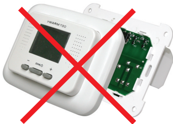
Рис. 9а Неправильное снятие крышки прибора
